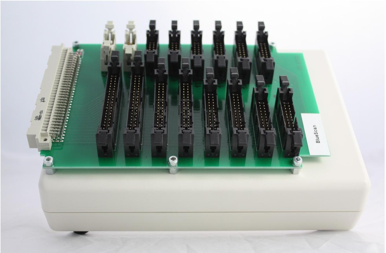
**Bezeichnung:** Prüfadapterbox Flachkabel
